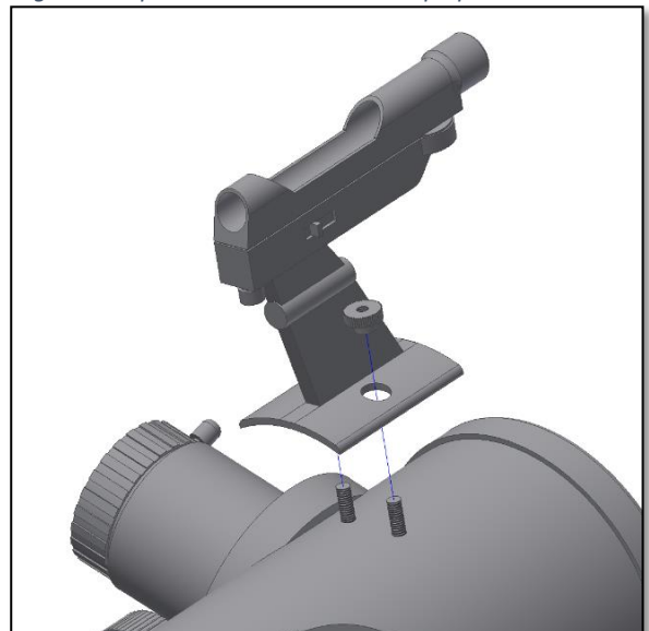
Fig. 11. Asegurar el tubo del buscador con tuercas de mariposa.
