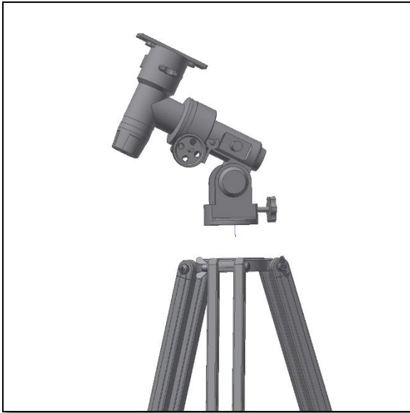
Fig. 4. Instalación de la montura ecuatorial.
