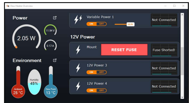
Fig 15 Si la consommation électrique d'un port dépasse le maximum, le port s'éteindra automatiquement. Pour réactiver le port, cliquez sur RÉINITIALISER LE FUSIBLE lorsque la charge sur le port en question est réduite.
